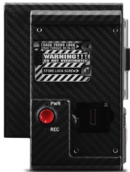
Рисунок HE блокируйте задний фокус во время настройки заднего фокуса
