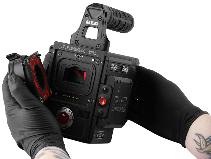
Рисунок Снимите байонет
