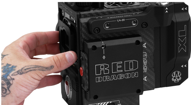
Рисунок Установите новый модуль OLPF
